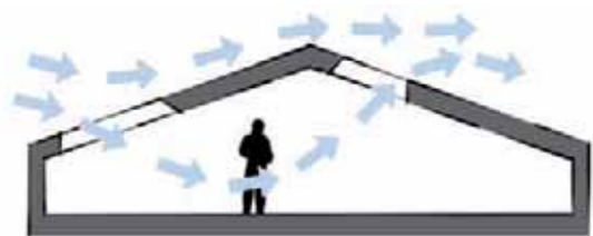
Ventilazione con effetto camino in mansarda semplice
