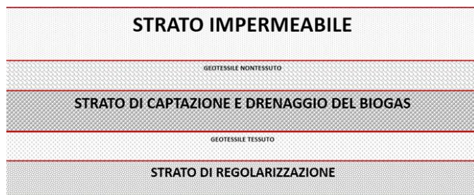
Fig.1 Rappresentazione schematica della copertura provvisoria (spessori degli strati non in scala. Non rappresentato il sottile geotessuto superficiale in HDPE, il quale funge solo da contenimento degli odori e da protezione, evitando il diretto contatto dello strato impermeabile con l’acqua meteorica, con gli animali e con l’uomo).
