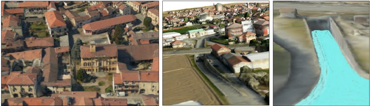
Figura 7: 3D model a) urbanizzato; b) il sottopasso (punto critico); c) simulazione idraulica nel sottopasso
