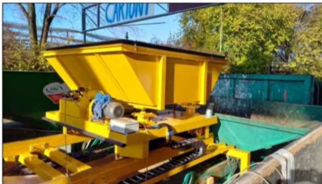
Figura 1 - Installazione dispositivo automatico di pesatura e conferimento in press-container rifiuti ingombranti
