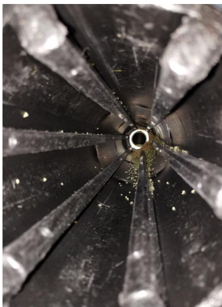
Figura 5 – Camera di caricamento tribo-caricatore Stokkermill
